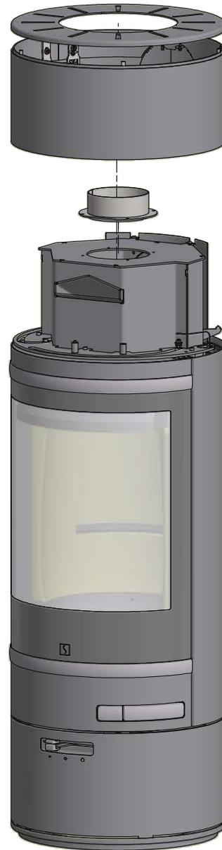
Dichtung auf dem Stutzen montieren.
