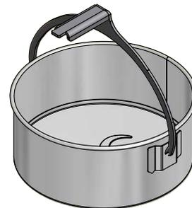
Nach der Entleerung wird der Aschenbehälter wie folgt im Kaminofen hineingesetzt: der Führungsbeschlag soll im Positionierungsloch angebracht werden, wonach der Aschenbehälter nach rechts gedreht werden kann, so dass der Griff in geschlossener Position steht.
