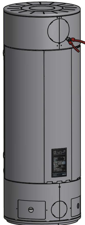
Den Schraubenzieher nach unten kippen und die Abdeckplatte lösen.
