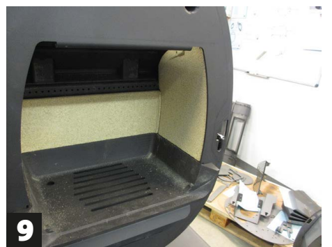
Rechte Seitenplatte montiert
